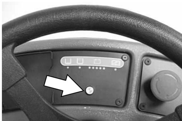
**Модель с ес-Н2О-системой:** Если зазвучит аварийный сигнал, и начнет мигать красная индикаторная лампочка ес-Н2О-системы, необходимо промыть модуль ес-Н2О-системы, чтобы возобновить функционирование ес-Н2О-системы (См. ПРОЦЕДУРА ПРОМЫВКИ МОДУЛЯ ес-Н2О-СИСТЕМЫ).
