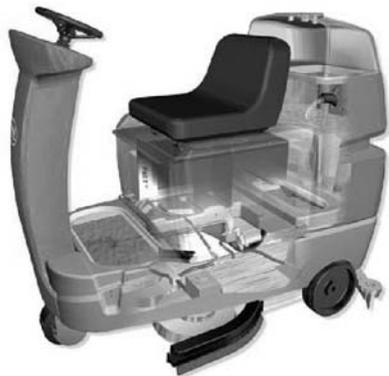
К узлам чистки относятся бак раствора, чистящие щетки или прокладки, швабра, вакуумный вентилятор и бак утилизации.
