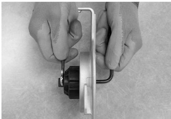
6. Поворачивайте промежуточный вал так, чтобы поднимать или опускать торец щетки, в зависимости от того, что нужно для выравнивания рисунка следа щетки. Затяните крепежный винт.
